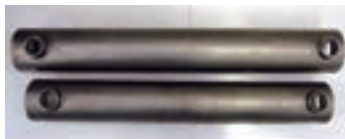
新しく開発されたプレキャスト部材接合用の継手
